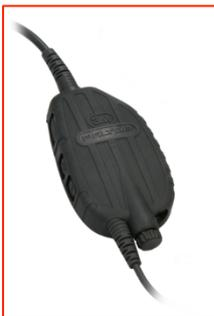
Il est également constitué d'un **boîtier de contrôle avec PTT** (Push To Talk) qui permet de **contrôler facilement la prise de parole, le volume ainsi que l'activation/désactivation de l'appareil**. Très maniable, il peut se **connecter directement** avec différents types de radio et le câble de connexion/déconnexion se change facilement lorsqu'une nouvelle radio est utilisée.
