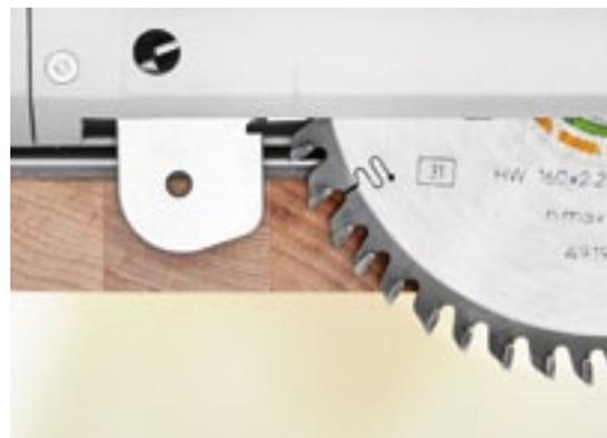
Sécurité et confort accrus : le couteau diviseur, avec ressort, sort avant la lame de scie. Il assure ainsi la sécurité et garantit un positionnement précis dans les rainures déjà existantes.
