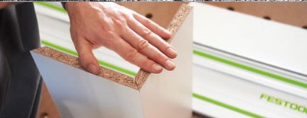
Des points de crantage permettent de définir directement les angles de 0° et 45°. Grâce aux réglages avancés de -1° à 47°, il est facile de réaliser des contre-dépouilles.
