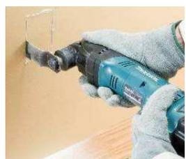
**Les lames scies plongeantes** autorisent la **découpe** dans les cloisons pour la pose de prises, d'éclairage... et la **coupe** de pièces de bois, de plastique ou de métal. Les différentes largeurs de lames offrent une précision de coupe selon les besoins.
