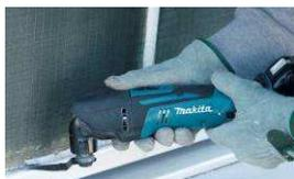
**Les spatules et la lame coupe-joints** permettent d'ôter les joints tendres, les coulures de peinture et de colle type silicone...
