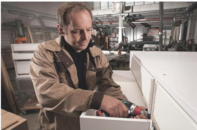
Grâce au renvoi d'angle, le professionnel peut également travailler avec la perceuse-visseuse PowerMaxx BS Quick dans des endroits difficilement accessibles. **Photo : Metabo**
