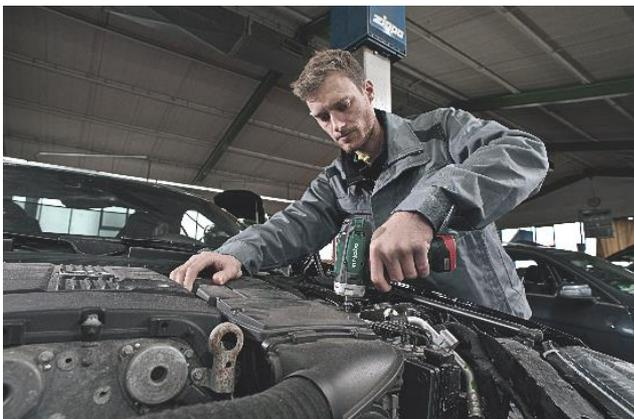
La broche à six pans creux aimantée de la perceuse-visseuse PowerMaxx BS permet d'effectuer des travaux de vissage sans mandrin. **Photo : Metabo**
