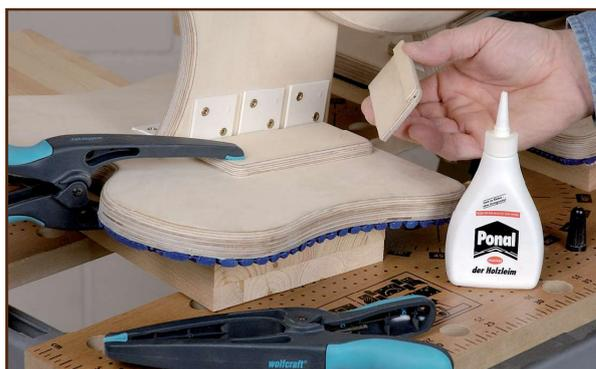
**30** Fixez les caches. Appliquez pour cela un peu de colle à bois sur la partie des caches qui vient en contact avec la patte (ou la palme), et mettez sous presse. Si vous utilisez un pistolet à colle chaude, vous pouvez également déposer la colle directement sur les équerres et dans ce cas, plus besoin de serre-joint.
