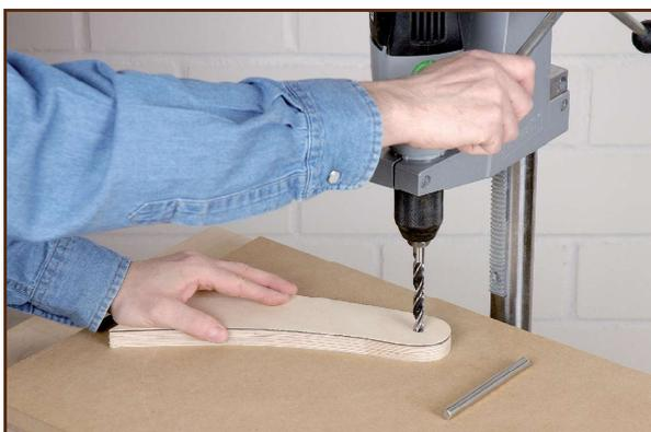
**11** Installez ensuite sur votre plan de travail, maintenu par des serre-joints, le corps et une grande aile (l'aile sous le corps). Placez enfin la patte arrière et reportez l'emplacement du perçage sur l'aile.
