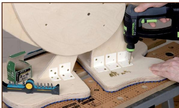
**29** Il ne vous reste plus qu'à réaliser des petits caches pour recouvrir les équerres. Utilisez pour cela des chutes de contreplaqué dans lesquelles vous usinez une feuillure afin de compenser l'épaisseur des équerres.
