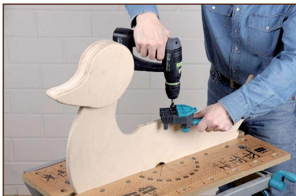
**15** Utilisez des centrés de Ø 8 mm pour reporter les emplacements des perçages sur l'assise dont vous aurez préalablement tracé l'axe (dans le sens de la longueur). Après avoir placé les centrés dans les trous percés sur le corps du canard, présentez l'assise en alignant le trait d'axe sur les centrés. Appuyez fermement sur l'assise pour que les pointes des centrés laissent une marque bien visible.
