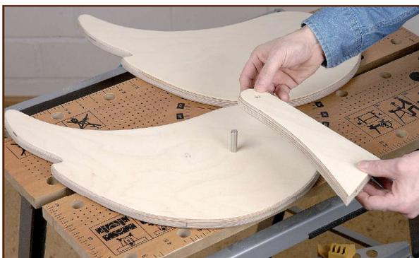
**20** Placez maintenant l'ensemble que vous venez de monter dans l'évidement du corps du canard, l'arrondi de la patte arrière en butée au fond de cet évidement. À partir de cette position, décalez légèrement l'ensemble ailes/patte arrière, pour que la patte puisse bouger librement. Ce décalage doit se faire dans l'axe de l'évidement, de manière à ce que le jeu ainsi donné à la rotation de la patte soit également réparti.
