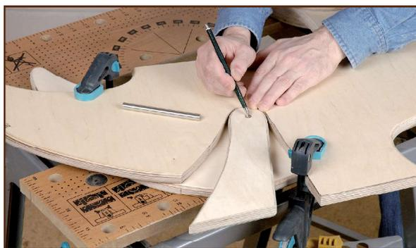
**12** Placez les deux grandes ailes exactement l'une sur l'autre et maintenez-les avec deux serre-joints. Avec un foret à bois de Ø 10 mm, percez un trou à travers les deux ailes d'après le repère précédemment tracé. Si vous ne possédez pas de perceuse à colonne ou de support de perçage, je vous conseille de percer les ailes l'une après l'autre pour limiter le risque de perçage en biais.
